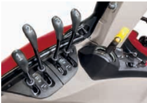
Bis zu vier mechanische Zusatzsteuergeräte sind für die Maxxum Modelle verfügbar.
