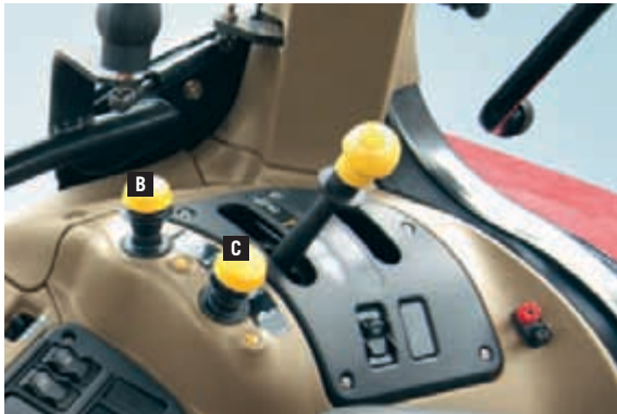
Einfach zu bedienen die Zapfwellenschaltung beim Maxxum, sowie ...
