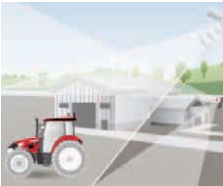
xFill überbrückt RTK Signalabschattungen bis zu 20 Minuten.
