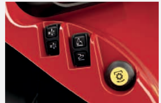
Außentaster ermöglichen einen schnellen und bequemen Geräteanbau.
