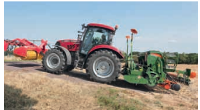
Aktive Stillstandsregelung: sorgt für sicheren Stand des Traktors am Hang ohne Betätigung der Bremsen.
