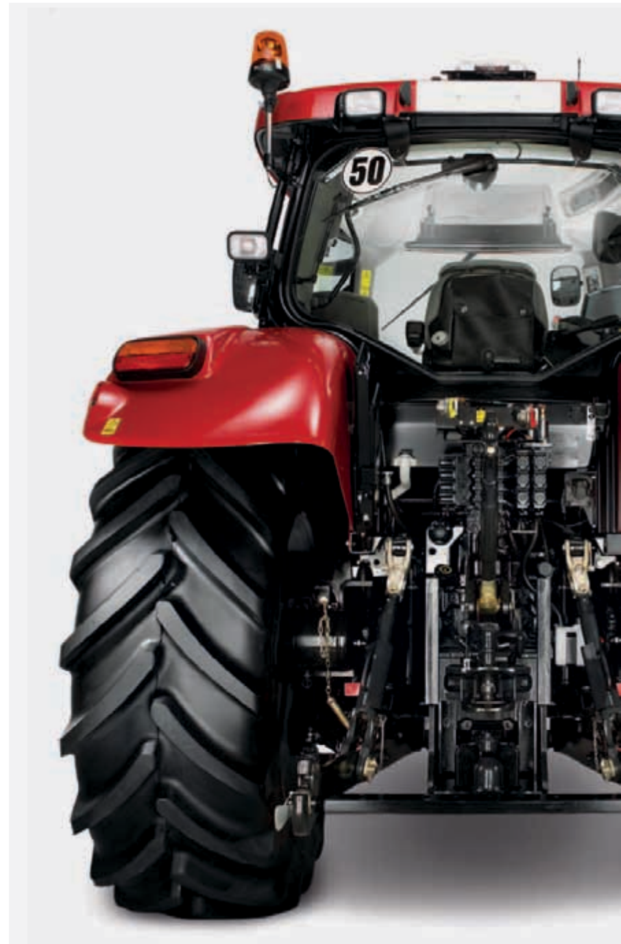
Am Heck stehen bis zu 4 elektrische Steuergeräte zur Verfügung.
