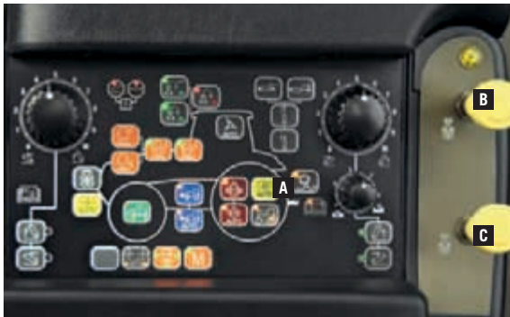
... beim Maxxum Multicontroller und Maxxum CVX. A – automatische Zapfwellenschaltung B – Frontzapfwelle ein/aus C – Heckzapfwelle ein/aus
