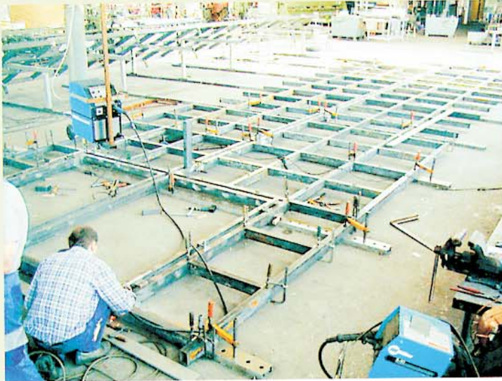
Der Rahmen für die Aufnahme der Glasscheiben der Torkonstruktion wird in der Werkstatt bei Brandl vorgefertigt.
